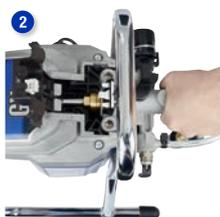
2 Rimuovere la sezione del pompante
