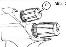
2. **VORSICHT:** Wenn Sie den Knopf (6) wieder auf den Regler (B) und vorher festziehen die Senkschraube T10 (C), aufsetzen, überprüfen Sie, ob dieser soweit gedrückt ist, dass er die Seite des sechskantigen Knopfes des Reglers selbst vollkommen bedeckt (Abb. 2).
