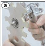
a. Enlever la buse (2-1), tandis que l'aiguille (2-2) reste tirée (en appuyant sur la gâchette), pour protéger le logement de l'aiguille.
