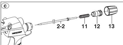
d. Le réglage du presse étoupe (3) doit toujours être effectué avec l'aiguille (2-2) montée, c'est à dire de la façon suivante : fermer manuellement par une rotation de 60 degrés environ, puis serrer à l'aide de la clé de montage.
