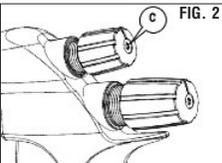
**ATTENTION:** en réinsérant le bouton (6) sur le réglage (B), et avant de visser la vis à tête fraisée T10 (C), vérifier que le bouton (6) soit pressé jusqu'à couvrir entièrement le côté du bouton hexagonal du réglage (Fig. 2)
