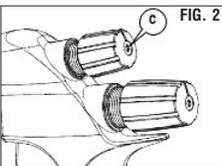
**FIG. 2 ATENÇÃO:** quando reinserir o botão (6) do ajuste (B), e antes de apertar o parafuso escareado T10 (C), verifique que esteja premido até cobrir completamente o lado do botão hexagonal do ajuste próprio (Fig. 2).
