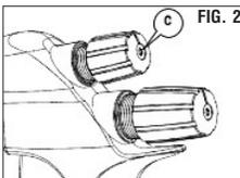
**WARNING:** När ställskruven (6) sätts in på regleringen (B), och innan du dra åt försänkta skruven T10 (C), se till att den pressas upp till helt täcka sidan av justeringsmuttern själv (Fig. 2).
