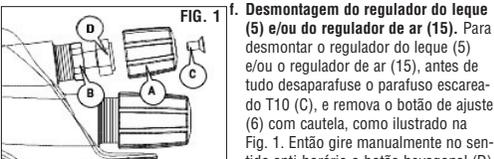
**FIG. 1 f. Desmontagem do regulador do leque (5) e/ou do regulador de ar (15).** Para desmontar o regulador do leque (5) e/ou o regulador de ar (15), antes de tudo desaparafuse o parafuso escareado T10 (C), e remova o botão de ajuste (6) com cautela, como ilustrado na Fig. 1. Então gire manualmente no sentido anti-horário o botão hexagonal (D)
