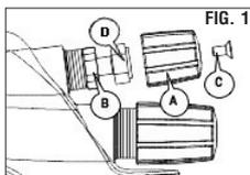
**f. Smontaggio della regolazione del ventaglio (5) e/o della regolazione aria (15)**. Per disassemblare la regolazione ventaglio (5) e/o la regolazione aria (15), innanzi tutto svitare la vite a testa svasata T10 (C) e rimuovere il dado di regolazione (A) estraendolo con cautela come illustrato in Fig.1.
