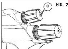
**ATTENZIONE:** quando reinserite il dado (6) sulla regolazione (B), e prima di avvitare la vite a testa svasata T10 (C), verificate che sia premuto fino a coprire completamente il lato del dado esagonale della regolazione stessa (Fig.2).
